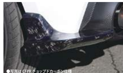
●写真はCFRP チョップドカーボン仕様 ■ リヤアンダースポイラー Rear Under Spoiler (Forged Carbon)
