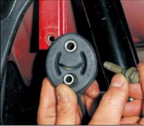
5 ステー最後部のゴムマウントをノーマルボルトを再使用して車体ステーに取り付けます。
